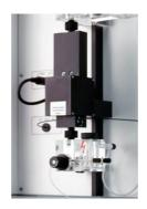
Die UV-Detektion ist die am häufigsten verwendete Detektion in der Flüssigkeitschromatographie. Auch für die ITP oder die ITP-CZE ist dieses Detektionsverfahren leicht anwendbar, wieder dient die Kapillare als Messzelle zur oncolumn Detektion.
